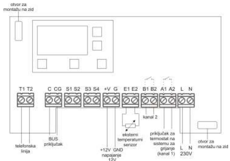
Za pravilno mjerjenje sobne temperature treba uređaj montirati na unutrašnjem zidu, na visini od oko 1,5 m. Na mjestu postavljanja mora biti osiguran protok zraka. Uredaj ne smije biti direktno izložen izvorima topline (radijator, sunce) ili propuhu.
