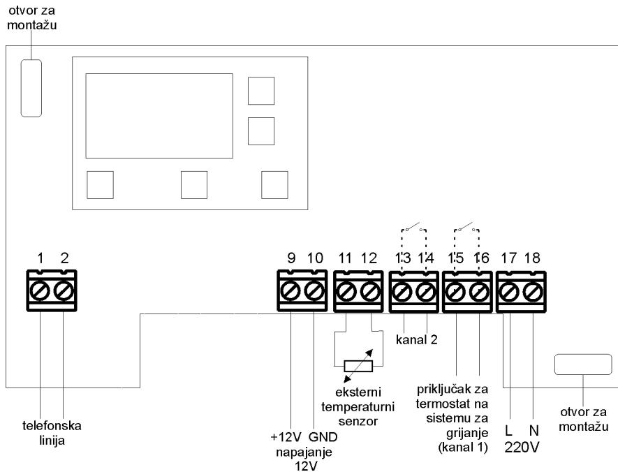
Za pravilno mjerjenje sobne temperature treba uređaj montirati na unutrašnjem zidu, na visini od oko 1,5 m. Na mjestu postavljanja mora biti osiguran protok zraka. Uredaj ne smije biti direktno izložen izvorima topline (radijator, sunce) ili propuhu.
